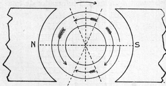
Los amperes-vueltas en cuadratura tienen la misma acción que una capa conductora interpuesta entre el inductor y el inducido. (Fig. 2). Sea:  $\sigma$ —la densidad lineal de la corriente en esta capa;  $\delta$ —el largo del entre-hierro simple;  $b$ —el desarrollo lineal de la pieza polar. La in-
