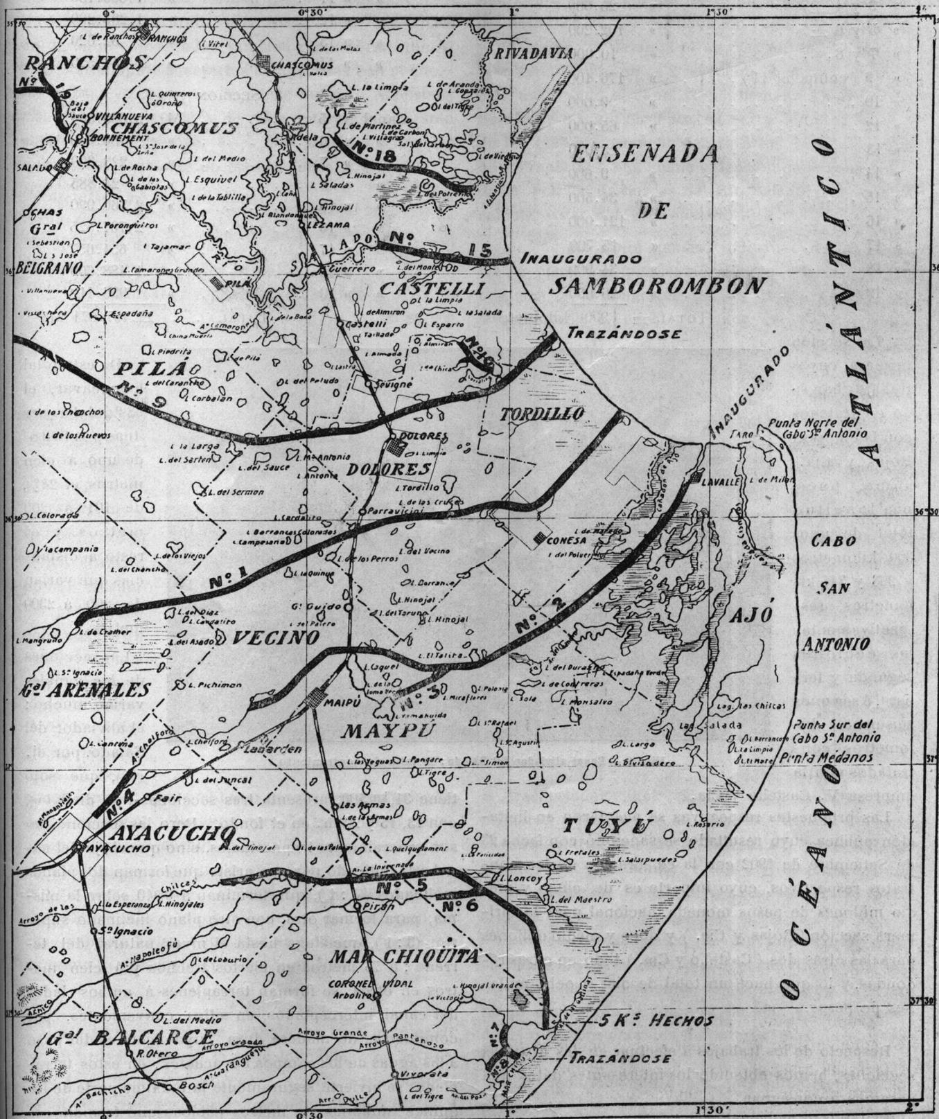
Fig. 1 — Desagües de la Provincia de Buenos Aires: Trazado de los canales principales.
