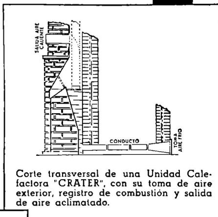
Corte transversal de una Unidad Calefactora "CRATER", con su toma de aire exterior, registro de combustión y salida de aire aclimatado.
