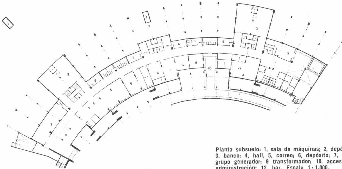
Planta subsuelo: 1, sala de máquinas; 2, depósito de equipajes; 3, banco; 4, hall; 5, correo; 6, depósito; 7, taller; 8, tablero y grupo generador; 9, transformador; 10, acceso de servicio; 11, administración; 12, bar. Escala 1:1.000.
