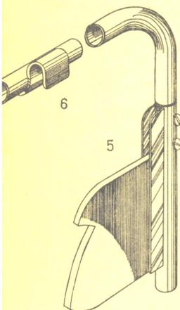
Detalles constructivos: 1, detalle del encastre a media madera del entramado al piso; 2, sistema de traba entre panel y estructura; 3, traba de cuatro paneles laterales; 4, traba para dos paneles frontales; 5, perfil U de encastre entre placa plástico y marco de panel; 6, soporte para colgar panel; 7, armado del panel por caño telescópico.
