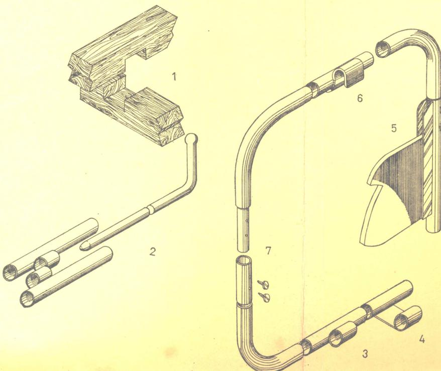
Detalles constructivos: 1, detalle del encastramiento de la madera del entramado al piso; 2, sistema de unión entre panel y estructura; 3, traba de cuatro paneles; 4, traba para dos paneles frontales; 5, perfil de encastramiento entre placa plástica y marco de panel; 6, soporte para colgar panel; 7, armado del panel por caño telescópico.
