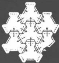
La carga aplicada a un blokret se distribuye radialmente.
