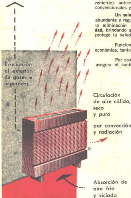
Circulación de aire cálido, seco y puro por convección y radiación
