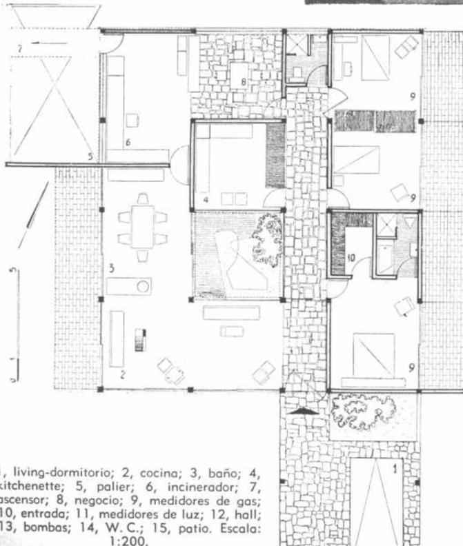
La losa del techo apoya sobre una estructura vertical metálica de columnas muy livianas. Esto, sumado al sistema modular adoptado permite ulteriores modificaciones en la planta.
