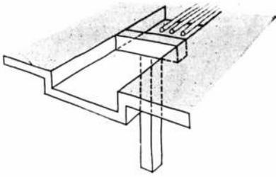
A la izquierda, una sección de perspectiva que muestra al estructura de los parasoles, el cielorraso central elevado y el corredor a manera de puente.
