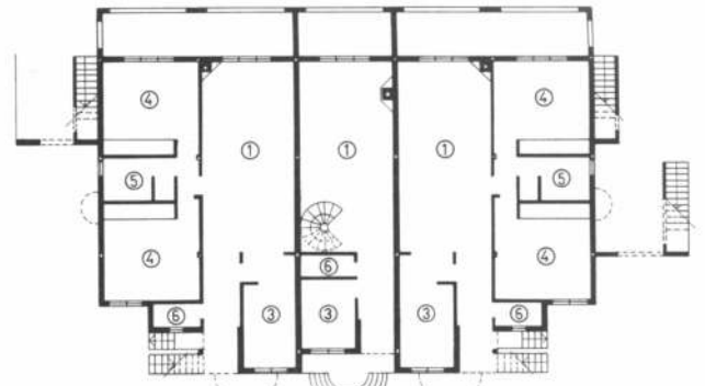
Planta baja. + 4.20 1) Estar. 2) Comedor. 3) Cocina. 4) Dormitorio. 5) Baño. 6) Toilete. 7) Dormitorio de servicio. 8) Baño de servicio
