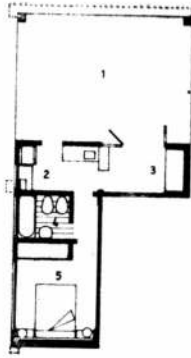
Planta intermedia del prototipo 00-40. 1, quincho. 2, kitchenette. 3, parrilla. 4, baño. 5, dormitorio. Escala 1: 250.
