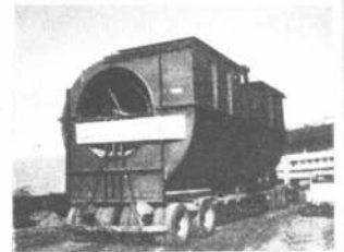
Las grandes dimensiones de los ventiladores centrifugos Carrier exigieron especial cuidado para su transporte
