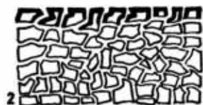
2. Muro tratado con "repelaqua": al evaporarse el solvente que contiene el producto se forma una zona de total repelencia al agua hasta varios milímetros de profundidad mediante la adhesión de una capa invisible de sílica sobre las partículas del material; no sella los poros y por eso la pared respira libremente; la duración efectiva es de 8 a 10 años.
