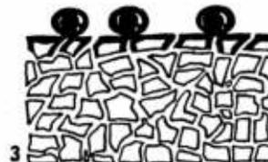
3. Efecto de la lluvia en una pared tratada con "repelaqua": no es absorbida por la pared y resbala por la superficie produciendo un efecto de lavado muy efectivo.
