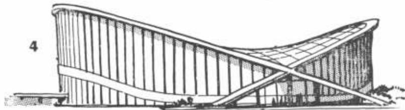
rio, entonces, proveer cables guías en los extremos de ambos sistemas de cables. Con esta medida se podía omitir la tensión previa de los cables.
