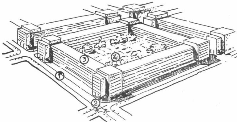
(1) Ensanche posible de calles céntricas y de avenidas mediante retiros de frente, en planta baja solamente - recobas - o en toda la altura.
