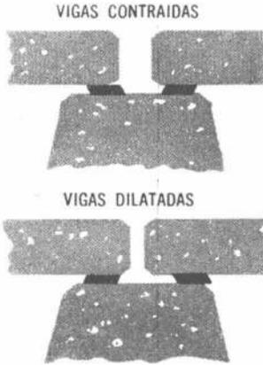
Los apoyos flexibles de neopreno Du Pont, permiten el libre movimiento de las vigas maestras de acero o de hormigón.
