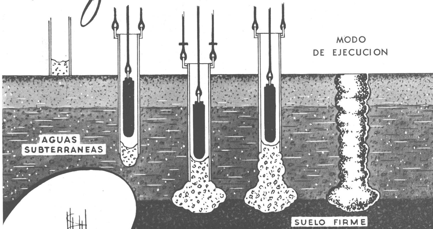
Su fundación es el sistema más rápido - económico y seguro por sus grandes ventajas: **GRAN DIAMETRO - SUPERFICIE RUGOSA Y SU BASE ENSANCHADA**, que aseguran una gran estabilidad sobre el suelo firme para soportar las cargas máximas de la construcción.
