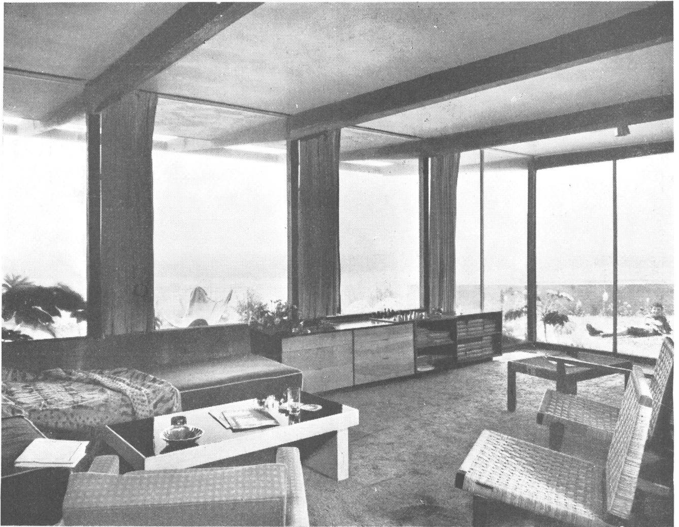
Vigas que se prolongan hacia afuera para soportar la saliente del techo, caracterizan al esqueleto.
