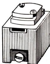
Del Sistema denominado “Intercambiable”, que permite utilizar, en una misma chapa, un botón de campanilla, una llave y un toma de corriente marca E.L.K.
