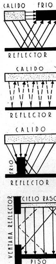
Otro factor que modifica la cantidad de calor radiada desde una superficie a otra es la naturaleza de las superficies mismas: superficies oscuras y ásperas radian y reciben calor más o menos diez veces mejor que superficies de metal pulidas. La mayor parte de los materiales de construcción, con excepción de vidrio, metales pulidos y azulejos de superficie lustrosa, poseen un 'factor de emisión' de más o menos 0.9 en comparación con un cuerpo negro.
