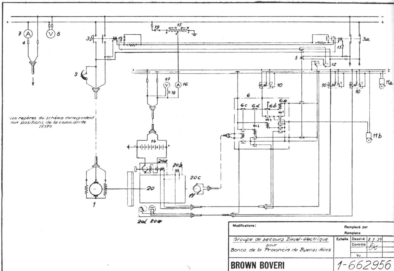
Fig. 9. — Esquema de funcionamiento del equipo de emergencia.
