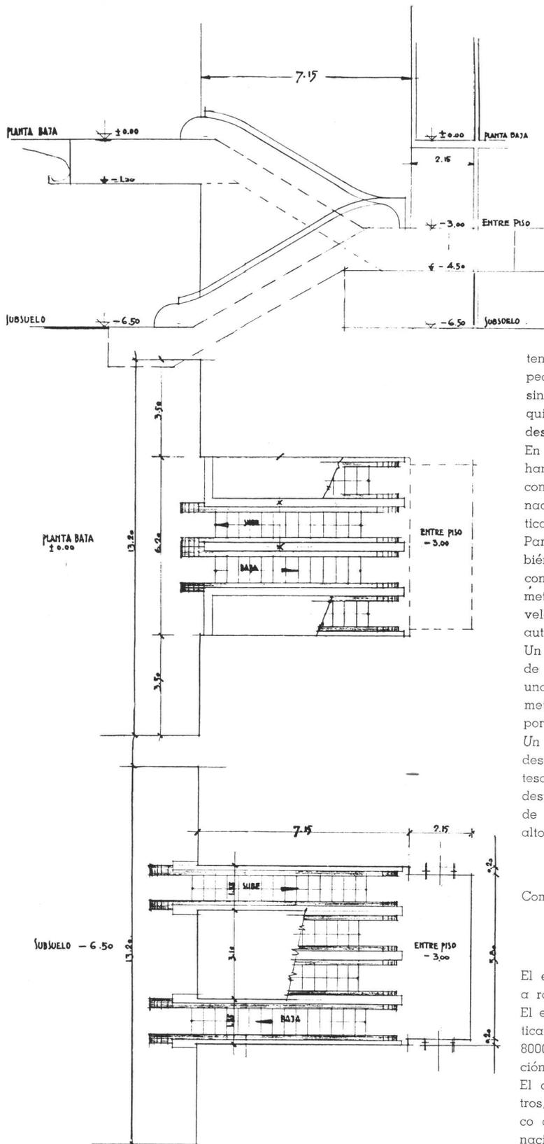
Fig. 21. — Esquema de la instalación de escaleras mecánicas.
