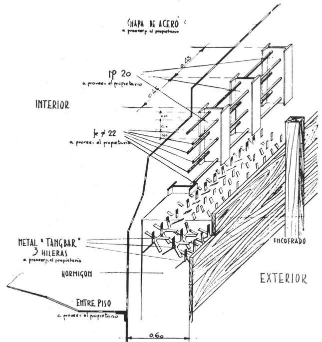
Fig. 26. — Piso, pared y techo para Tesoro de efectivo y Cajas de seguridad.
