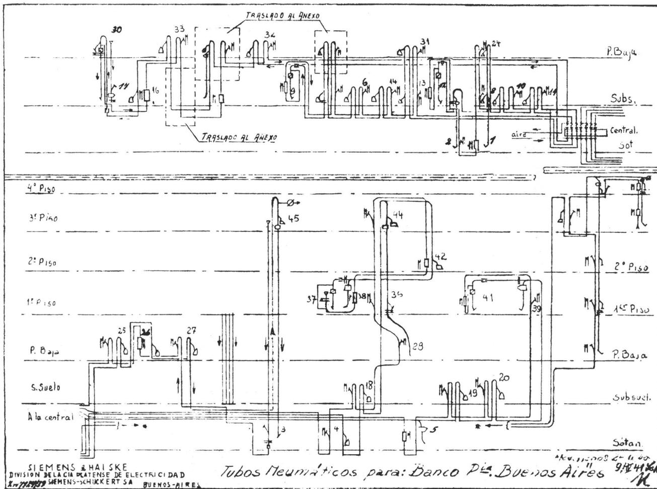
Fig. 22. — Esquema de la instalación de tubos neumáticos.
