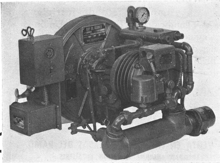
2 Quemadores "RAY" para 100 % Fuel Oil "AR-131" Control completamente automático con bomba y ventilador directamente acoplados al motor eléctrico.
