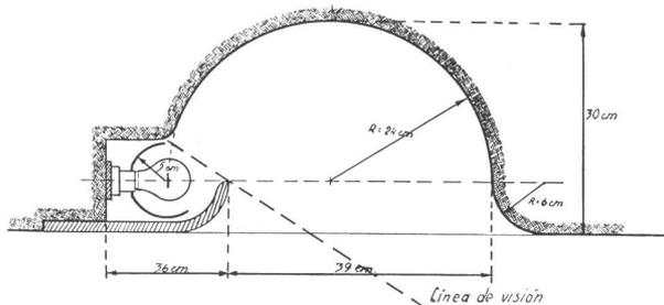
Fig. 4. — Detalle constructivo de la iluminación que muestra la Fig. N° 3
