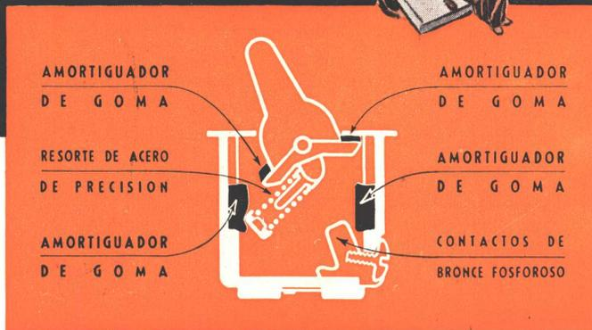
**CORTE DE UNA LLAVE "ATMA":** Al funcionar la palanquita interruptora, los topes de goma amortiguan el ruido del golpe, transformándolo en un sonido sordo, perceptible solamente en la habitación donde está colocada la llave. Las partes elásticas de bronce fosforoso y el potente resorte de acero aseguran un corte rápido y un contacto seguro.
