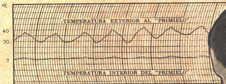
Se ha comprobado científicamente que la temperatura ideal para la protección de los alimentos está entre 4° y 10° centígrados y que por arriba o por abajo de estas dos temperaturas límites la descomposición de los alimentos es inevitable y más o menos rápida.
