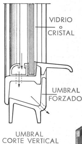
Las 3 flechas negras del corte indican el recorrido del agua de condensación hasta su salida al exterior.
