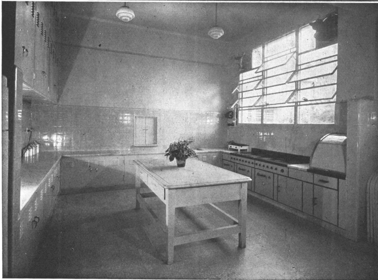
ARQS. O'FARRELL y VILLEGAS. - Residencia particular del Dr. Alberto de Gainza Paz en Belgrano. - ARRIBA, baño de la señora, revestido en mármol "Acqua Bianca". - ABAJO, cocina provista de cocina eléctrica, muebles de acero. En la ventana 2 extractores de aire para asegurar su renovación.
