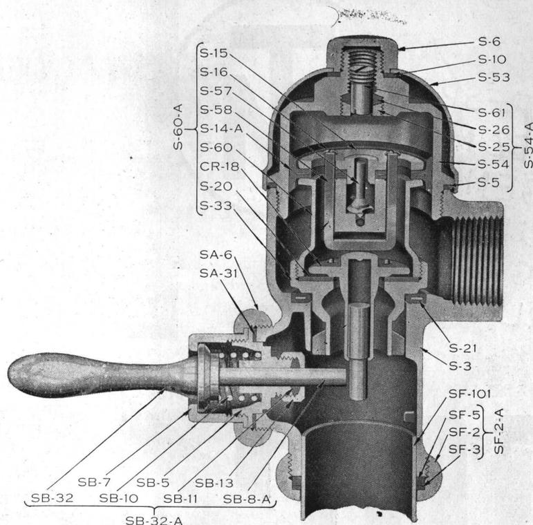
La STAR es una válvula superior para edificios, pues es exactamente igual a la NAVAL para buques, que funciona con aguas turbias, salobres y saladas, con la diferencia que la STAR es para agua dulce y su exterior es diferente.
