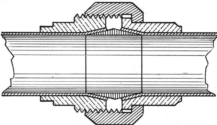
Corte longitudinal de una unión cónica a mandril, característica de los Caños de Bronce "TRIUNFO", demostrando la unión perfecta entre los dos caños, sin aumento ni disminución del diámetro interior.
