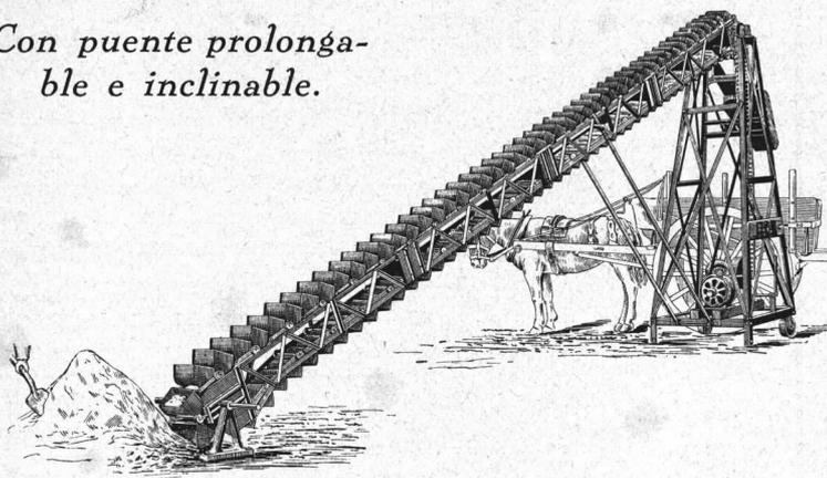
**M**ODELO económico y fácil de transportar. Puede colocarse fácilmente en el interior de los sótanos y emplearse hasta la línea de edificación, descargando directamente sobre el carro, sin ninguna molestia para los transeúntes. Por medio de un largo puente dividido en varias secciones, fácil para armar y desarmar, puede ser alargado o inclinado según lo exijan las excavaciones.
