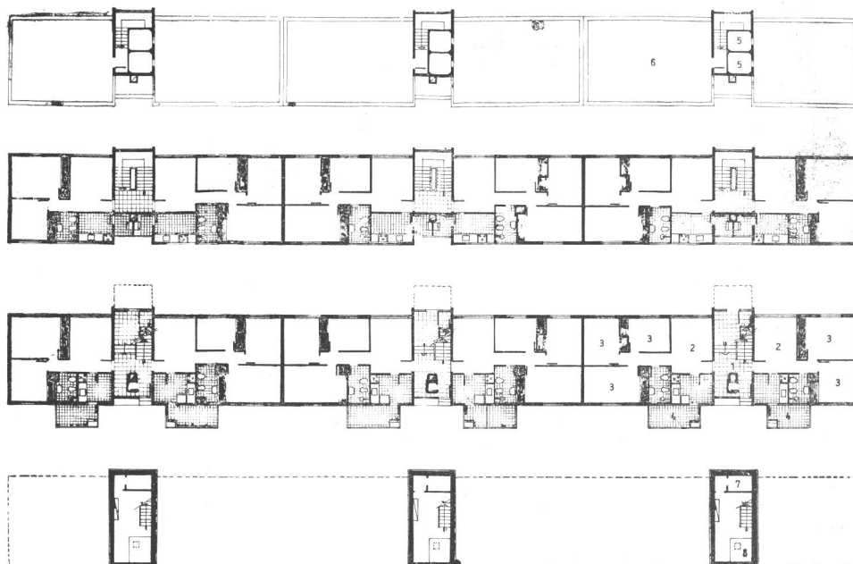
Planta tipo de los edificios de planta baja y tres pisos con seis departamentos por piso: 1, accesos; 2, estar y comedor; 3, dormitorios; 4, lavaderos; 5, tanques de agua; 6, hornos incineradores; 7, medidores de gas. Escala 1:500.
