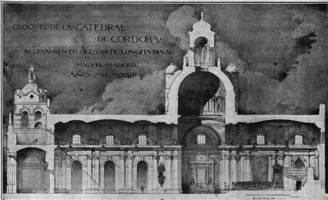
LA CATEDRAL. — SECCIÓN LONGITUDINAL, por M. Madero.
