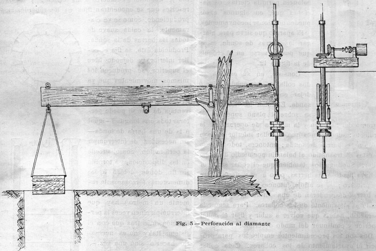
Fig. 5 — Perforación al diamante
