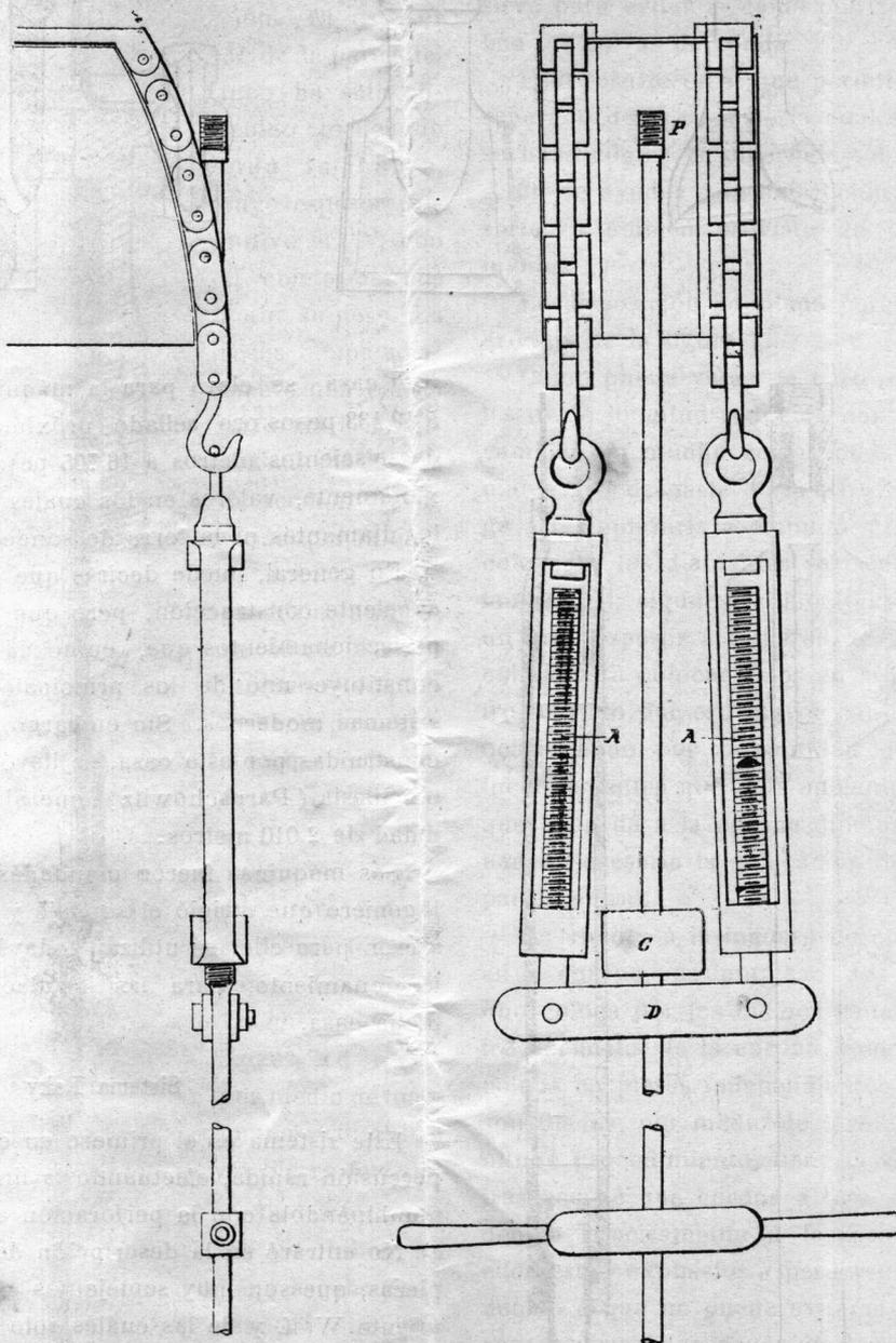
Fig. 4 — Colisa para la perforación al trépano
