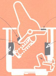
**CORTE DE UNA LLAVE "ATMA":** Al funcionar la palanquita interruptor los toques de goma amortiguan el ruido del golpe transformándolo en un sonido sordo, perceptible solamente en la habitación donde está colocada la llave. Las partes elásticas de bronce fosforoso y el potente resorte de acero aseguran un corte rápido y un contacto seguro.
