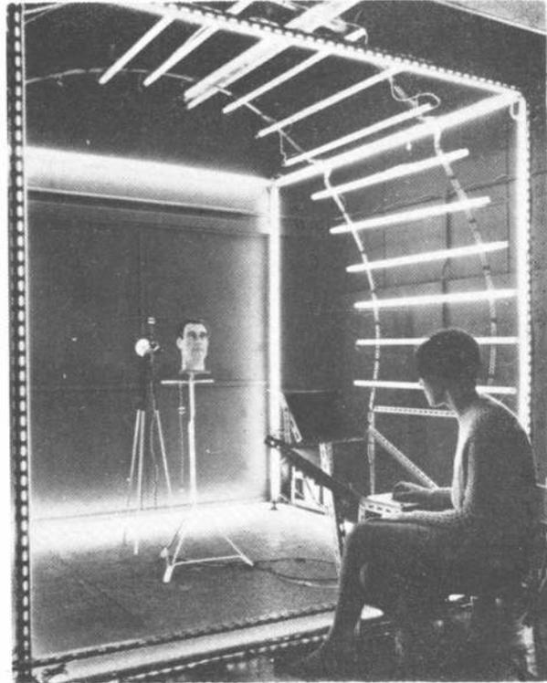
Para objetos situados en el interior de un edificio cabe elegir el "modelado" apetecido y crear las ventanas y el alumbrado que permitan conseguirlo. En la fotografía puede verse el sistema vectorial Pilkington: recinto escalar en el que se pueden efectuar cambios de dirección intensidad y luz total para lograr efectos de "modelado" en el maniquí del centro.
