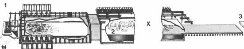
Proceso Float: 1, horno regenerativo; 2, baño donde el cristal fundido flota sobre estaño fundido (en el sector X, el cristal puede recibir el proceso Spectra-Float, para convertirse en coloreado o transparente); y 3, almacén de corte, examen y distribución.
