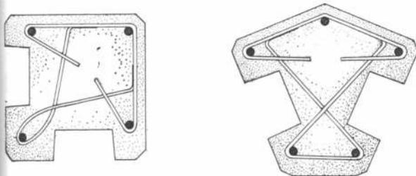
Arriba: corte mostrando el sistema adoptado para la zona Oeste, que tiene manto de tosca y permitió el uso de columnas de hormigón. Abajo se muestran detalles del armado de las columnas esquineras utilizadas en los distintos ángulos de caletas y dársenas.
