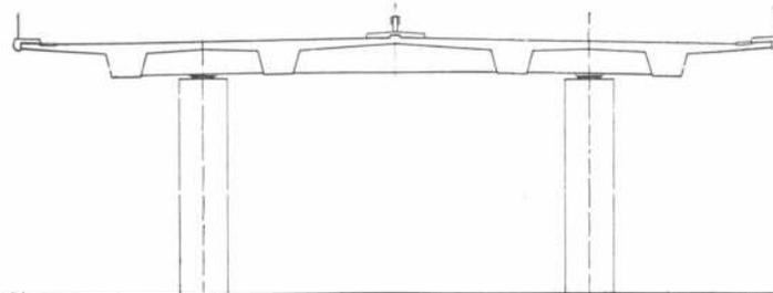
Debido al tránsito de trenes sobre las vías del FCB Mitre se utilizaron vigas pre-moldeadas de perfil T (abajo, izquierda). Corte (abajo, derecha) de una rampa curva de acceso.
