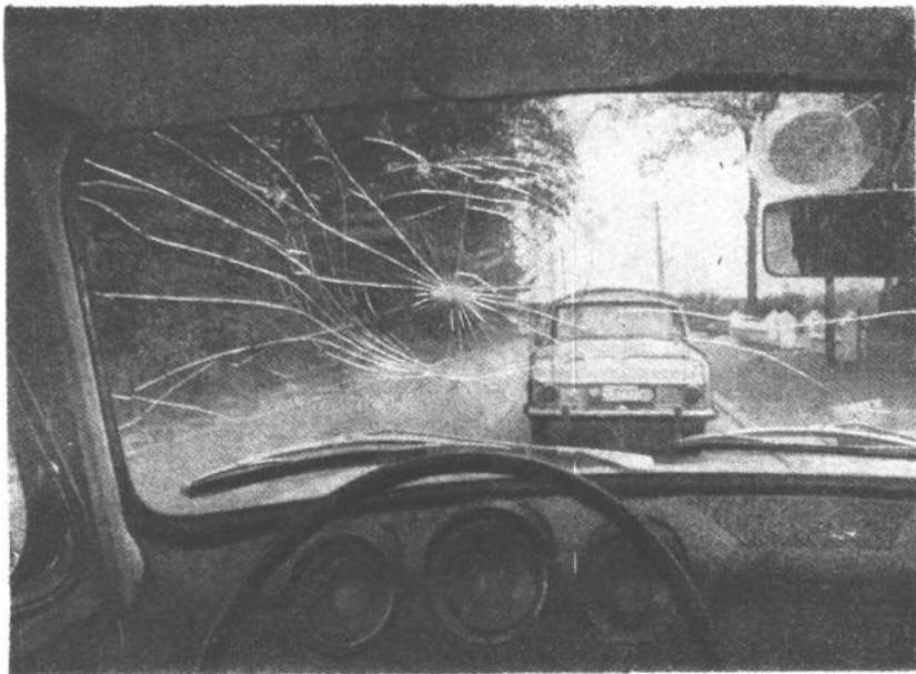
en dos o tres capas superpuestas tiene una gran resistencia a la penetración de proyectiles, ya que debido a su elasticidad, el plástico absorbe casi toda la energía del impacto, impidiendo su solidez el pasaje del proyectil. El vidrio, a su vez, actúa como un soporte de la película, protegiéndola de la influencia de los agentes atmosféricos que causarían la pérdida de sus cualidades.
