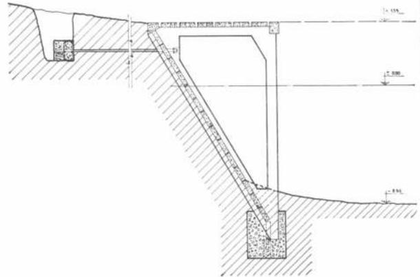
Arriba: corte mostrando el sistema de muelles con pilotes y pórticos de hormigón armado adoptado para la zona Este.
