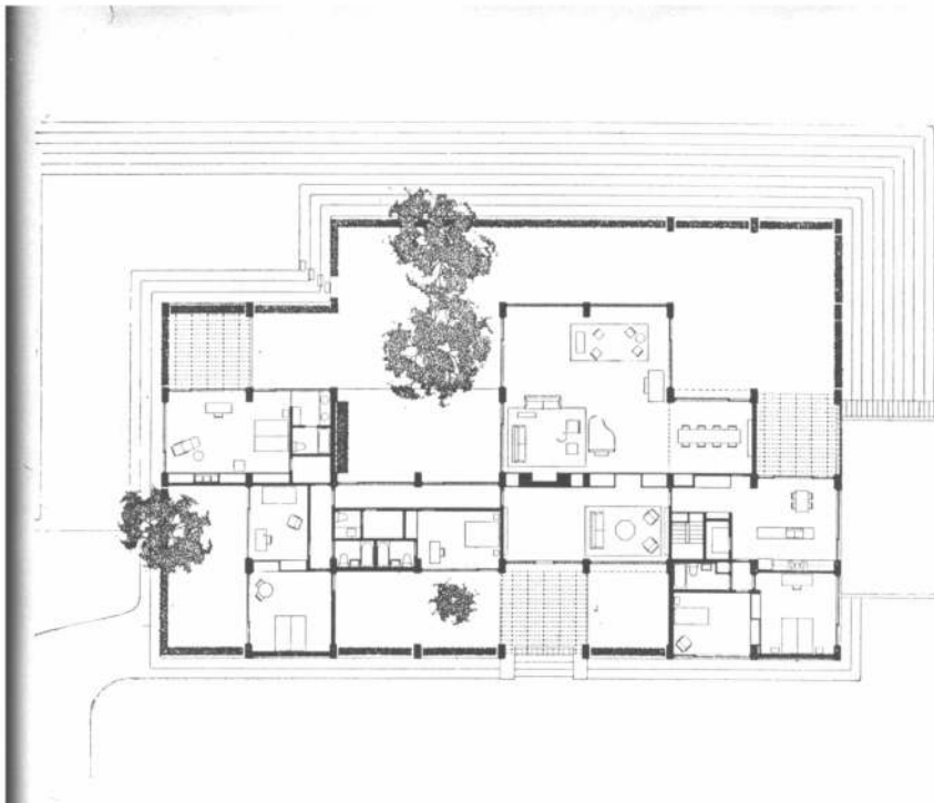
Planta general de la casa: la entrada se advierte abajo, notándose los pilares rectangulares de las arcadas y pérgolas. El vestíbulo es la base del desarrollo.
