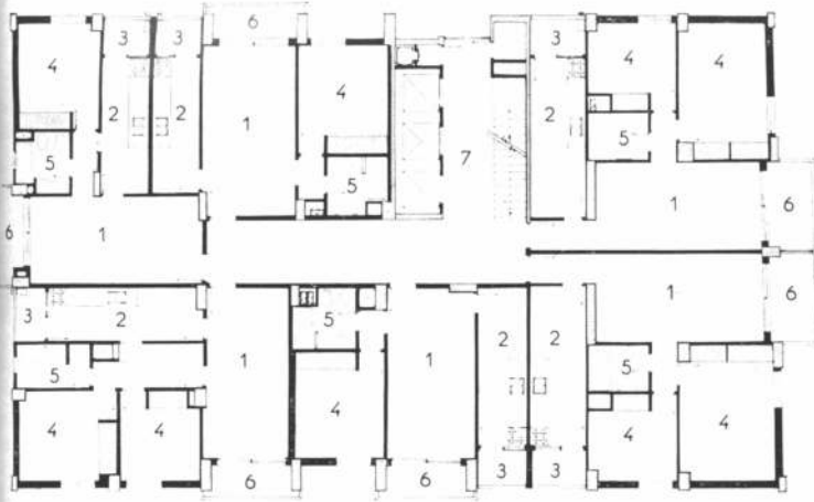
←←← Planta 19 subsue'lo. 1, rampa acceso automóviles calle Escalada. 2, estacionamiento del supermercado. 3, pasarela al estar del supermercado. 4, vacío sobre sala de máquinas de supermercado. 5, local equipos de refrigeración para cámaras frigoríficas y heladeras de la planta baja. 6, taller de mantenimiento. 7, control. 8, bauleras torre 1. 9, bauleras torre 2. 10, estacionamiento torres. 11, estación transformadora Segba. 12, vacío sobre servicios generales torre 2. 13, depósitos. Escala 1:500.
