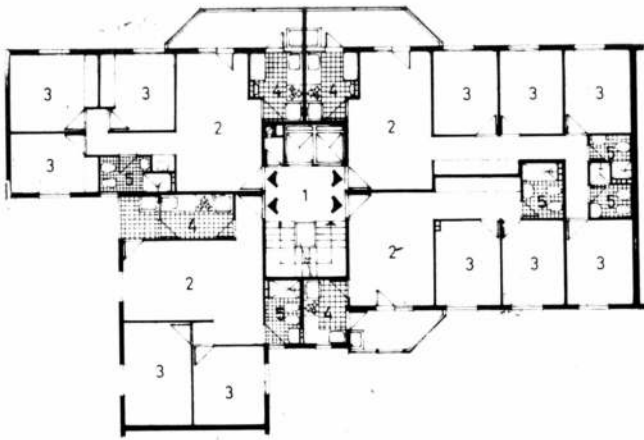
Planta tipo de torre: 1, palier; 2, estar; 3, dormitorio; 4, cocina; 5, baño. Escala 1:250.
