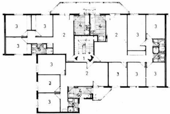
Planta tipo edificio 2: 1, palier; 2, estar; 3, dormitorio; 4, cocina; 5, baño. Escala 1:250.
