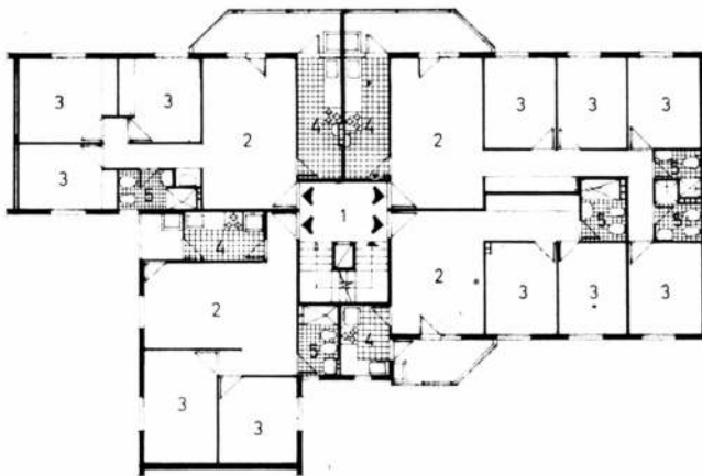
Planta tipo edificio 1: 1, palier; 2, estar; 3, dormitorio; 4, cocina; 5, baño. Escala 1:250.
