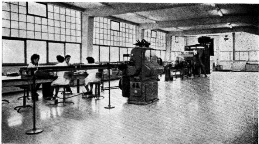
6.— Los pisos de una fábrica de jabón, en Suiza, construidos con mezclas epoxídicas, resultan resistentes a los productos químicos utilizados por esta industria.
