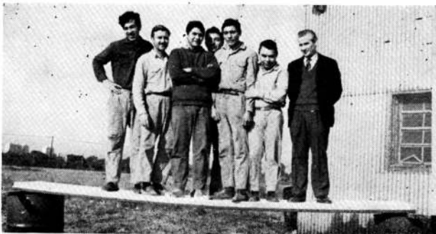
8: Una prueba de carga "humana", que evidencia la resistencia a la flexión del panel sandwich.
