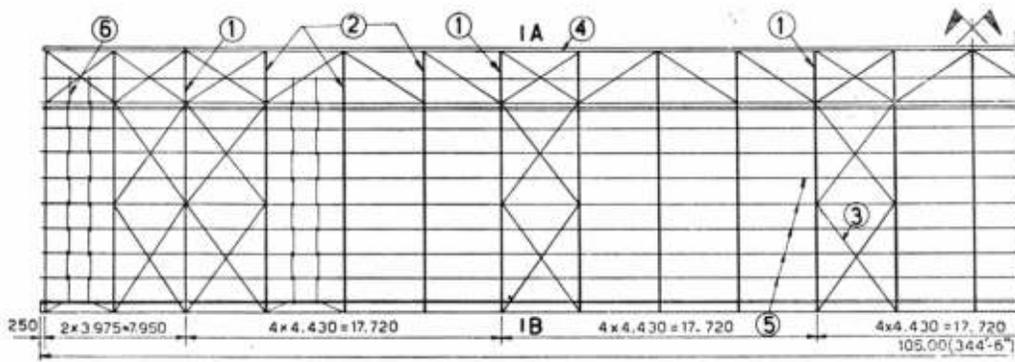
Fig. 3. — Planta de la cubierta: 1 — Jácenas principales. 2 — Jácenas intermedias. 3 — Arriostrados. 4 — Canales. 5 — Correas. 6 — Arriostrado de vértice en todos los tramos.
