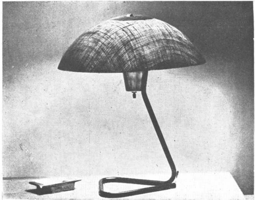
LAMPARA DE MESA: Pantalla de material plástico, imitación tejido de arpillera, su diámetro es de 35cm.; un tubo de acero de 1/2" de diámetro y terminado al duco forma el pie de esta lámpara, cuya altura total es de 42cm.
