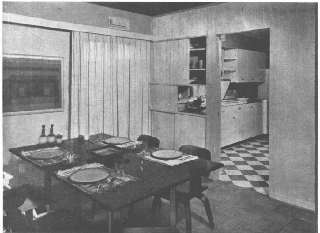
Desde el rincón comedor hacia la cocina. Los pisos son de paneles de madera de forma cuadrada y la cocina de baldosas blanco y negro. La cocina y el comedor están separados por un tabique divisorio aprovechado como placard hacia ambos lados.
