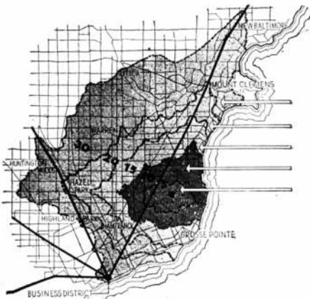
Los análisis básicos del mercado hechos por el arquitecto, establecieron la zona de influencia comercial del nuevo centro de negocios, hasta una distancia de 30 minutos en automóvil. La forma irregular del mercado es debida a que el radio no es función de la distancia, sino del tiempo. En realidad las ventas al detalle potenciales del nuevo centro, son tres veces superiores a los 60 millones de dólares calculados por Hudson.
