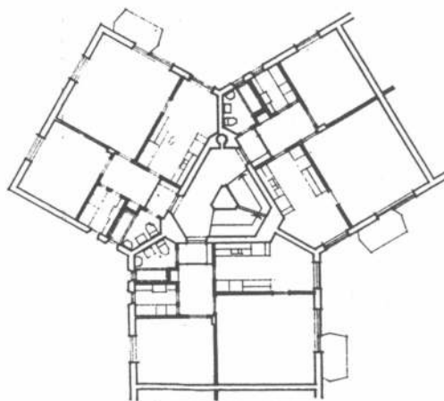
Fachada y planta de la casa en estrella de Rosta en Orebro. Cada punta contiene un departamento. Estas casas pueden ser construidas en unidades aisladas o unidas en diferentes formaciones.
