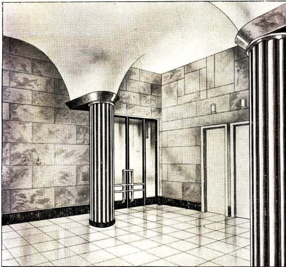
Hall de entrada, Edificio Safico. (Columnas revestidas con "Staybrite")
