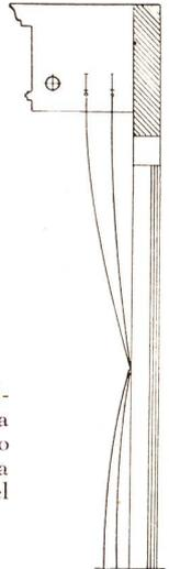
Corte esquemático mostrando la ubicación del tubo fluorescente para la iluminación del cortinado.
