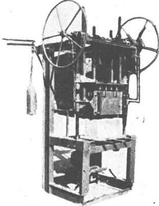
**...PARA FABRICAR BLOQUES DE HORMIGON VIBRADO**
