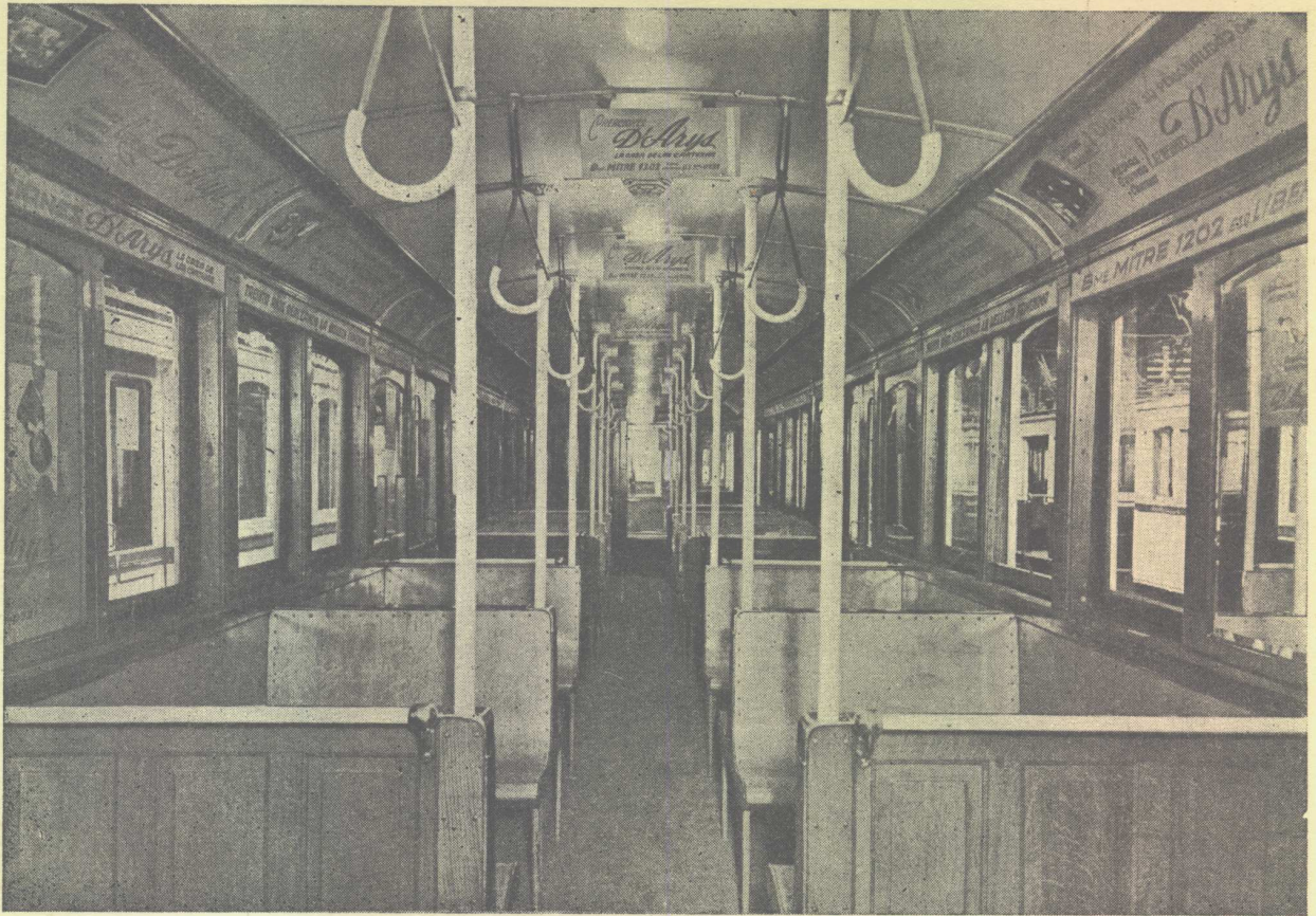
Coche subterráneo de la Corporación de Transportes de la Ciudad de Buenos Aires con Piso Plástico
