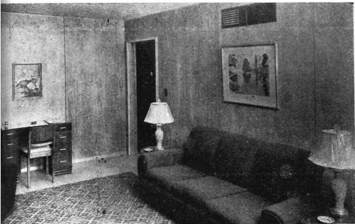
Vista del Living-room de la casa baja. Madera terciada de abedul aparente. La junta entre elementos ídem. La rejilla es la salida del aire caliente
