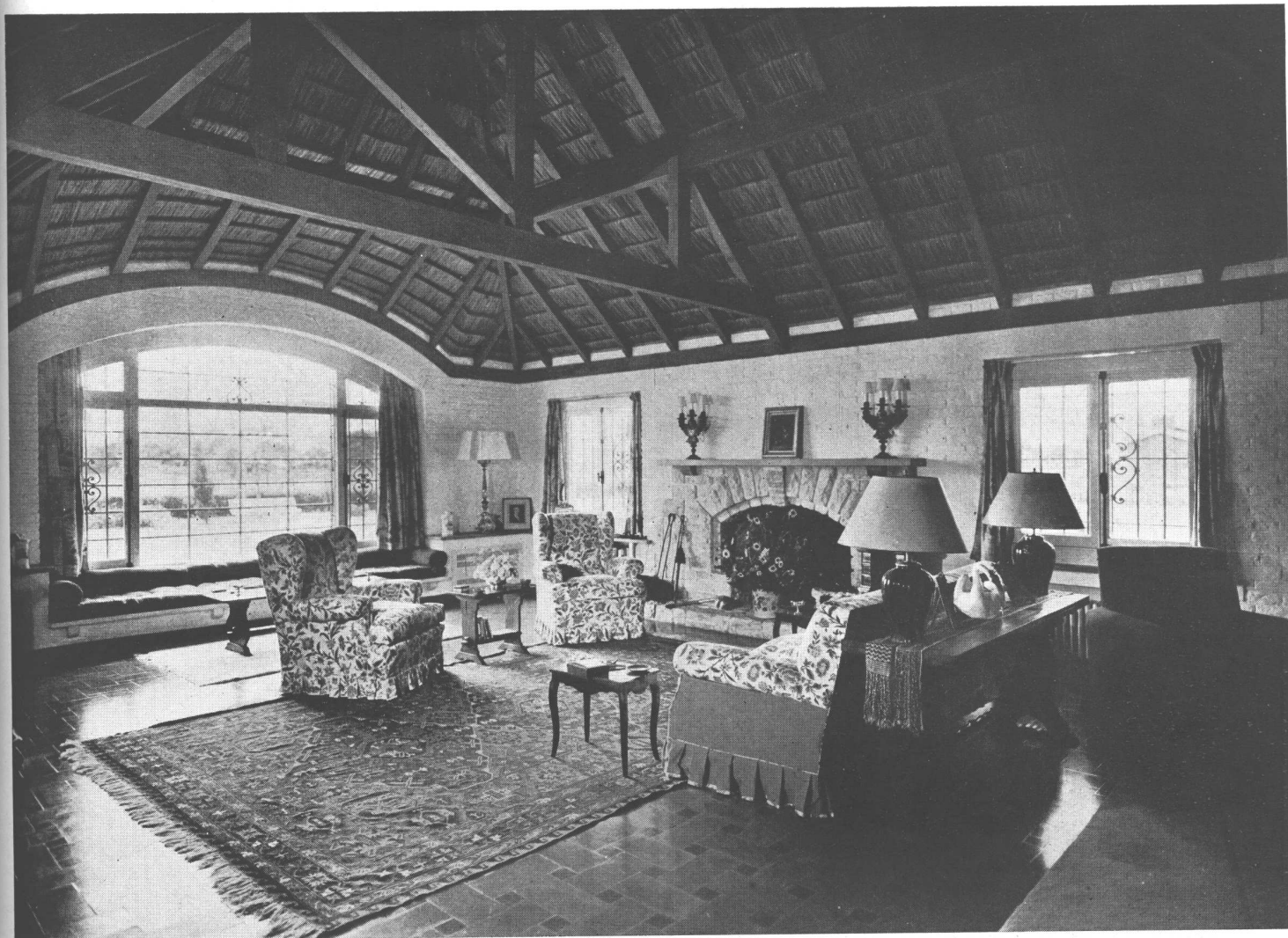
Una vista del living room, con detalle del gran ventanal mirando al Nordeste, con un banco fijo entre dos mesitas, formando tapa radiadores. El acabado es el siguiente: paredes de ladrillos blanqueados, piso de mosaicos de dos tonos de verde, cabriadas y tapas de muebles embutidos y antepechos de ventanas de roble patinado de color gris verdoso; el resto de la carpintería blanca con herrajes negros. Estufa de piedra de Mar del Plata de color ligeramente violáceo.
