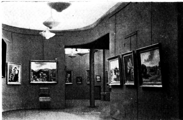
Fig. 1. — Interior de un museo alumbrado con luz indirecta. Nótense los artefactos que se destacan sobre el fondo claro del cielo raso
