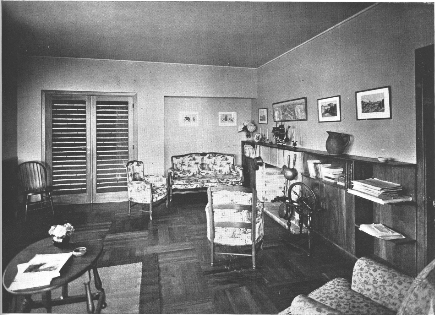
ARQS. ASLAN Y EZCURRA. Casa en San Isidro: el living room. Las puertas están constituidas por un bastidor de cedro, sosteniendo arpilleras de color naranja, los barrotes son de caña malaca natural. La chimenea de baldosones refractarios de 0.32 de lado. El piso es de viraró nudoso.
