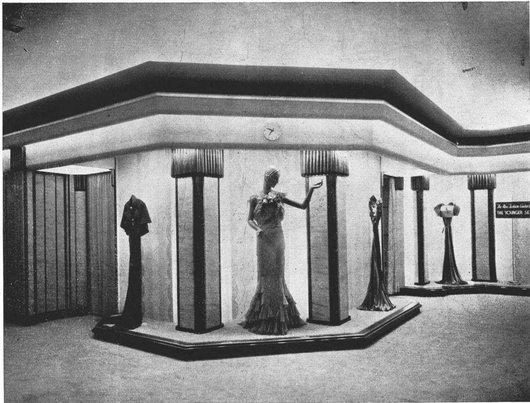
Arq. L. Blanc, L. K. I. B. A. — Salón de modelos de Harrods, Londres. Una de las tarimas de exposición combinada con la decoración de las paredes. El fondo es de cristal grabado e iluminado de atrás. La cornisa es en forma de canaleta con luz difusa para el cielo raso y escalonada abajo con luz difusa para iluminar las tarimas. Trabajo ejecutado por Fredk Sage & Co. Limitada, Londres
